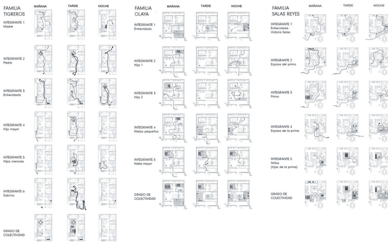
FIGURA 22 Mapas de uso de los casos de estudio a lo largo del día por cada miembro familiar, representando la interacción con los objetos de la casa. Fuente: Elaboración del equipo de investigación.
